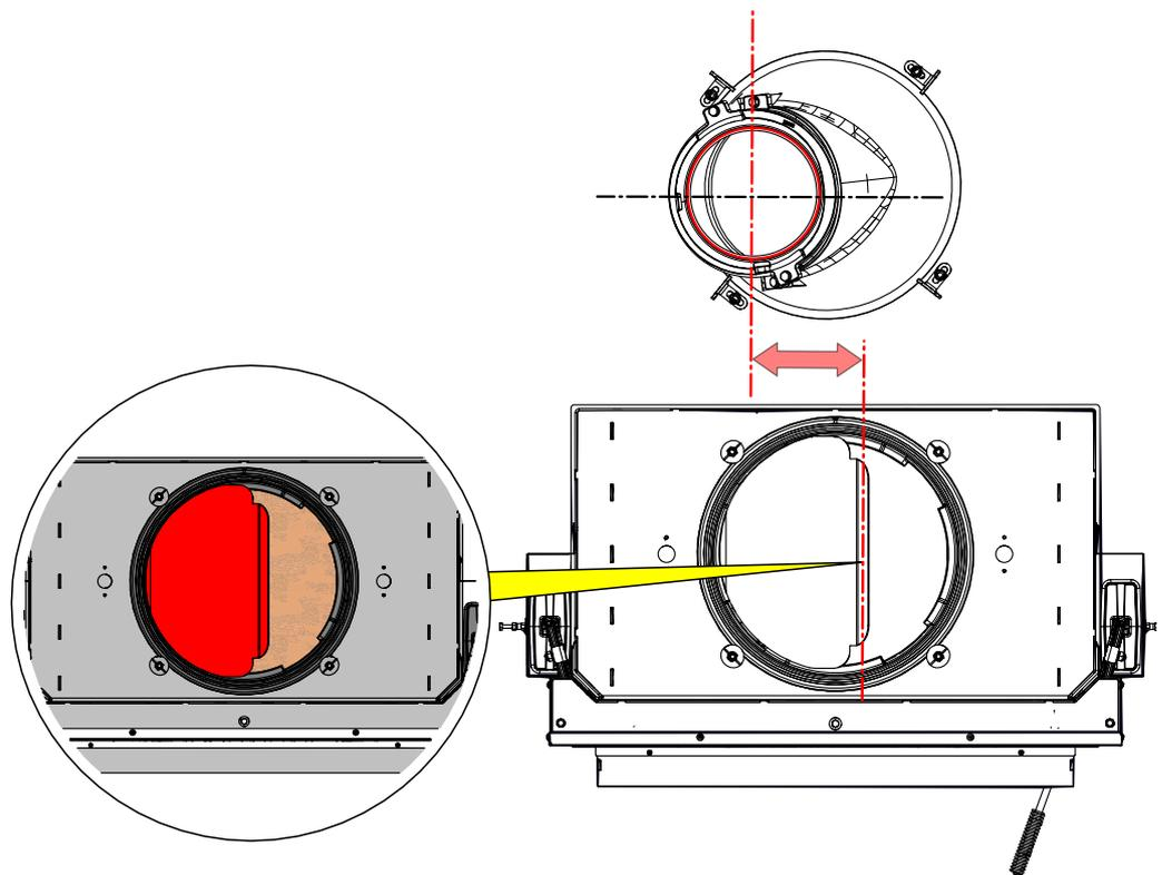
**4) Beispiel D: mit drehbarer Gusskuppel mit Wärmetauscherring - nach hinten - senkrecht bzw. waagrecht**
