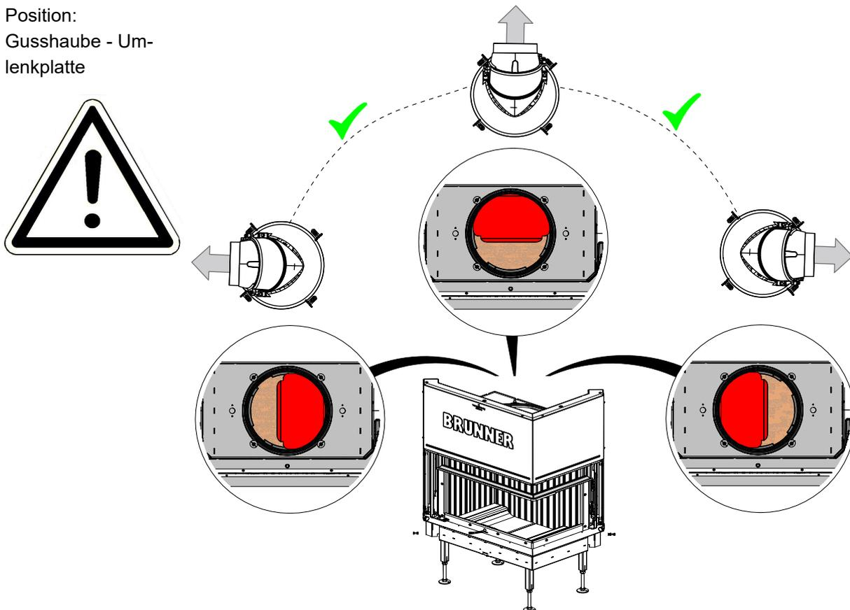
**Beispiele für Position Umlenplatte : Anschlussvariante für Abgase:**
