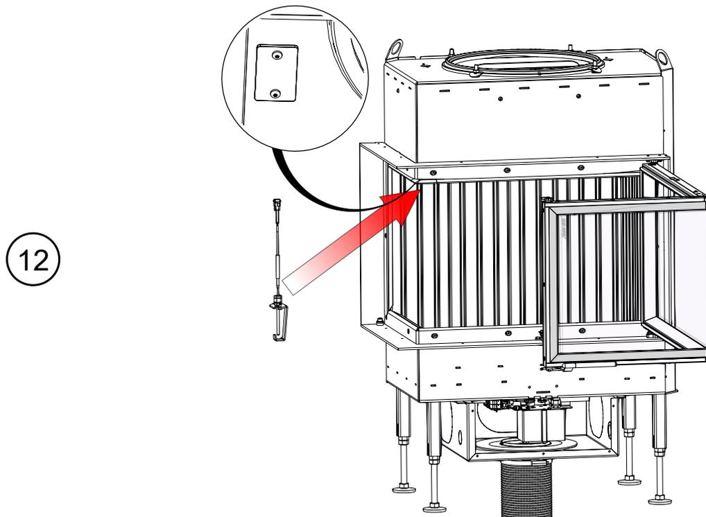
Varianten Kabelführung - Thermoelement: rechts bzw. links
