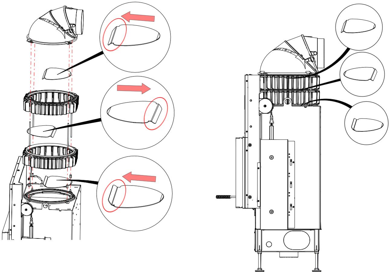
**Prinzip der Abgasführung bei Wärmetauscherringe**
